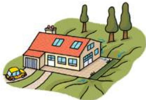
Noue et fossé
